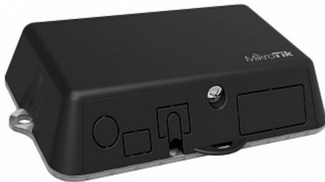
В маршрутизаторе установлена СИМ-карта для доступа маршрутизатора в сеть Интернет. Через сеть Интернет связь с помощью туннеля OpenVPN организована связь до виртуального маршрутизатора OPNsense, который обеспечивает связь маршрутизатора Mikrotik с вашим виртуальным сервером.
